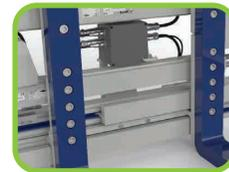
電子制御を可能にし、位置、速度、負荷情報などのフィードバックデータをCANopenプロトコルを使用して車両へ送信できるため、アタッチメントへのセンサ取付けを削減することができます。
